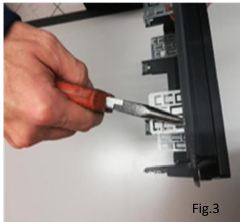
Una volta determinata l'altezza corretta del telaio inferiore sulla mascherina, posizionare ai n.4 angoli le staffe (E) fornite in dotazione nel kit e bloccare le stesse al bordo esterno della mascherina radio. Aiutarsi con un cacciavite per piegare la linguetta desiderata delle staffe -Fig.2- e bloccare in modo solido e stabile la struttura mediante l'uso di una pinza -Fig.3-.
