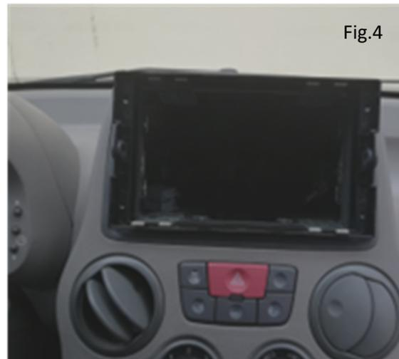
Installare sulla propria auto la mascherina radio dotata del telaio inferiore di supporto appena montato alla stessa. -Fig.4-
