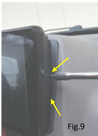
Utilizzando le viti fornite nel kit, fissare i perni vincolando definitivamente il supporto e la radio in auto. -**Fig.9-**
